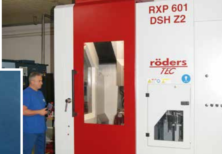
A maga nemében országos szinten egyedülálló Röders RXP601DSHZ2 öttengelyes megmunkálóközpont a I-es üzemben kapott helyet
