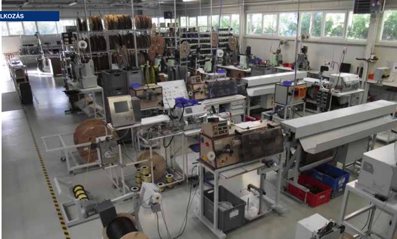
A Macher Zrt. 2500 négyzetméteres üzemcsarnokának egy részlete a kábeldaraboló gépekkel
